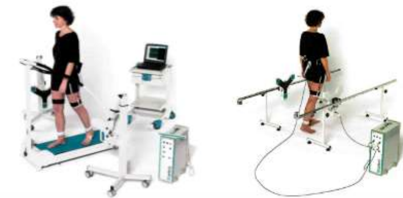
รูปที่ 2.5 แสดงเครื่อง 3D Real Time Gait Analysis on Treadmill or Walk ขณะการใช้งาน
