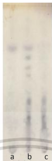
ภาพที่ 4.11 ผลการวิเคราะห์ผลิตภัณฑ์ด้วยโครมาโตกราฟีแผ่นบางที่เกิดจากปฏิกิริยาทรานส์ไกลโคไลเลชันของแอนโรไซยานินในกระเจียบแดงกับมอลโตซิลบีตาไซโคลเด็กซ์ทริน
