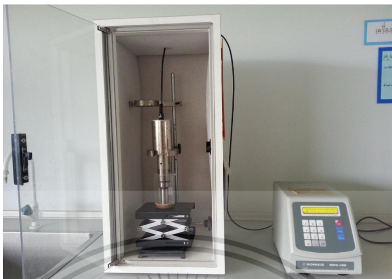
ภาพที่ ๓.๓ การสกัดน้ำมันเมล็ดคองุ่นด้วยวิธี UAE
