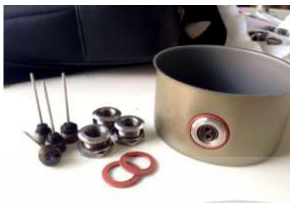
ภาพที่ ๕ อุปกรณ์สำหรับเสียบ Thermocouple เพื่อหาค่า F0
