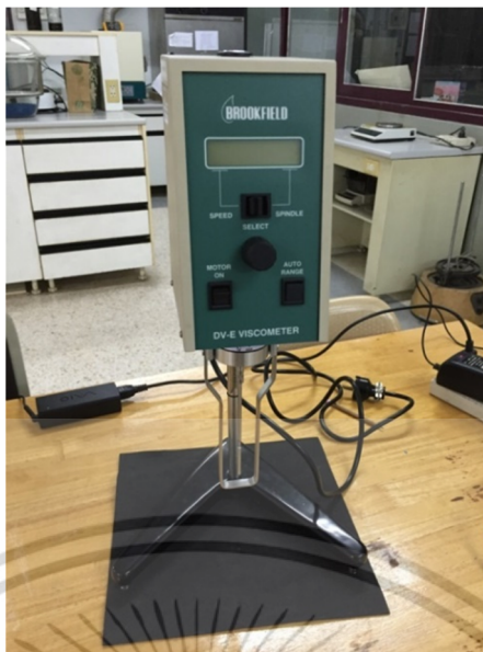
รูปที่ 3.8 Rotational Viscometer (Brookfield, DV-E)
