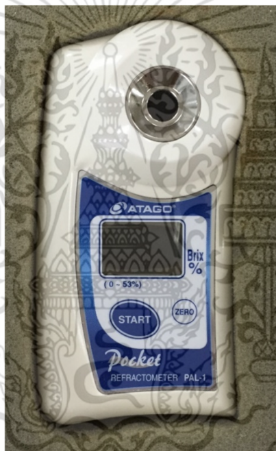
รูปที่ 3.13 Pocket Refractometer (Atago, Model PAL-1)
