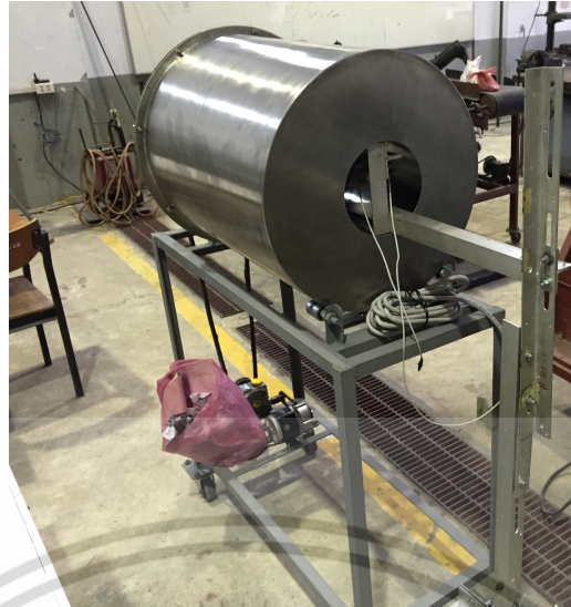
รูปที่ 3.2 อุปกรณ์ในการให้ความร้อนแป้งมันสำปะหลัง
