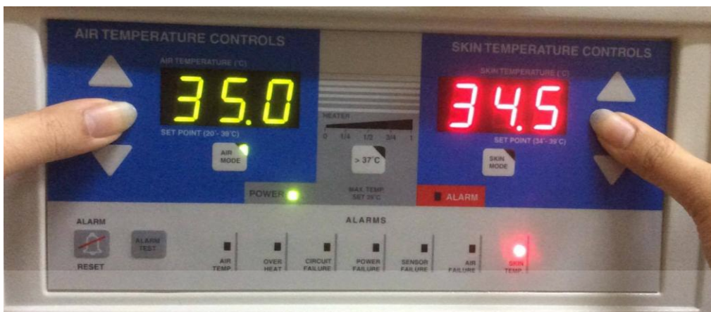
รูปที่ 4.10 แสดงค่าอุณหภูมิของเครื่องให้รังสีความร้อนสำหรับทารกแรกคลอด เมื่อทำงานไปแล้ว 25 นาที
