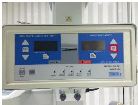
รูปที่ 3.13 แสดงการวิธีการปรับตั้งค่าอุณหภูมิในการทำงานของเครื่องให้รังสีความร้อนสำหรับทารกแรกคลอด
