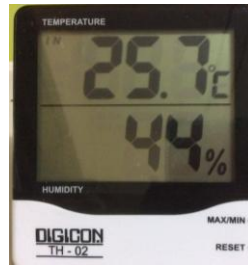
รูปที่ 3.9 แสดงภาพเครื่องวัดอุณหภูมิห้องที่ใช้ในการทดสอบ
