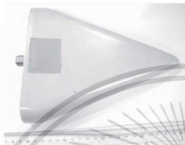
Fig. 8. Log-periodic dipole antenna (Walkins-Johnson AR7-15A).
