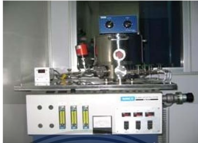
รูปที่ 3.11 เครื่อง PECVD ที่ใช้ในการสร้าง
