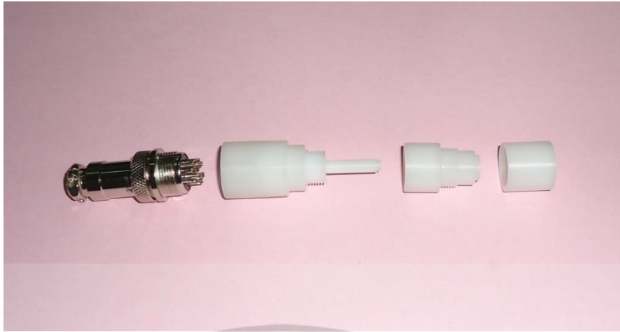
รูปที่ 3.29 ตัวเก็บบรรจุหัววัดออกซิเจนแบบแอมเปอร์เมตริก
