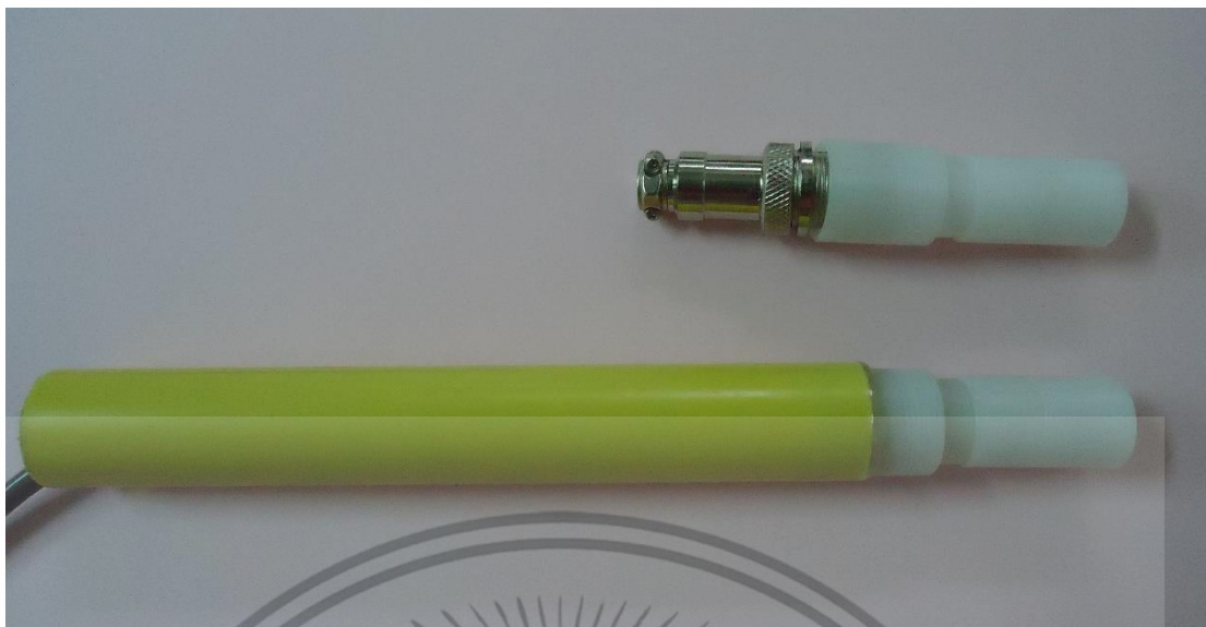
รูปที่ 4.30 หัววัดความเข้มข้นของออกซิเจนในสารละลาย
