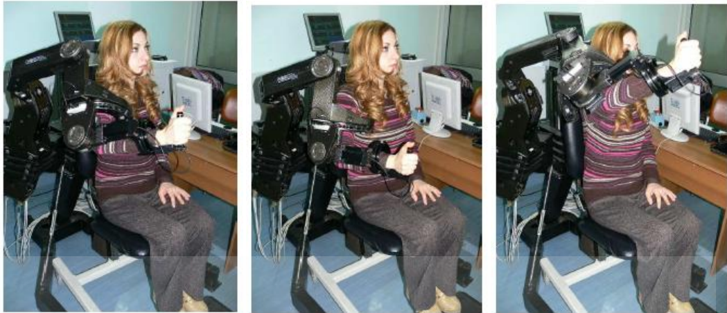
รูปที่ 2.24 การฟื้นฟูด้วยระบบ [15] โดยการสอดแขนขวาเข้าไปในแขนหุ่นยนต์ L-EXOS โดยผู้ป่วยจะต้องใช้มือจับบริเวณส่วนปลายของแขนหุ่นยนต์ พร้อมทั้งเคลื่อนแขนไปตามทิศทางที่การฟื้นฟูได้กำหนด
