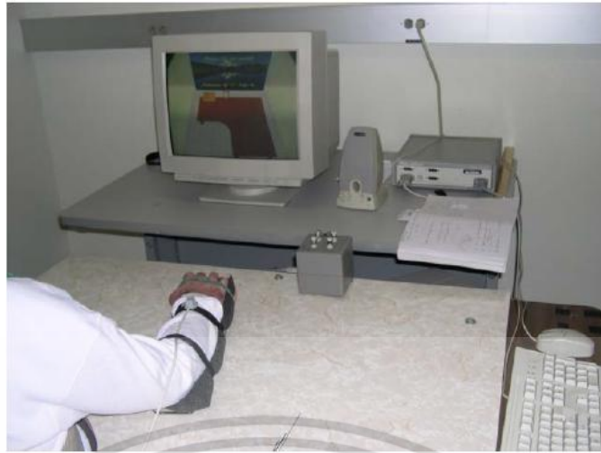
รูปที่ 2.27 แสดงการใช้งานระบบ Rutger ARM [16] สำหรับการบำบัดแขน โดยสอดแขนเข้าไปในที่สวมใส่แขนที่วางอยู่บนโต๊ะตัดแปลงแล้วเคลื่อนแขนไปตามทิศทางที่เกมส์ได้กำหนดไว้บนจอคอมพิวเตอร์
