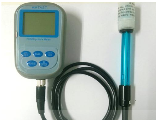
รูปที่ 3.9 เครื่องวัดค่าความเป็นกรด-ด่าง รุ่น Model PH900
