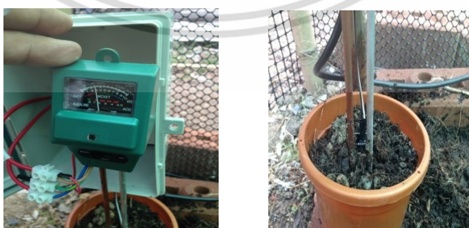
รูปที่ 3.22 การสอบเทียบอุปกรณ์วัดความชื้นในดิน
