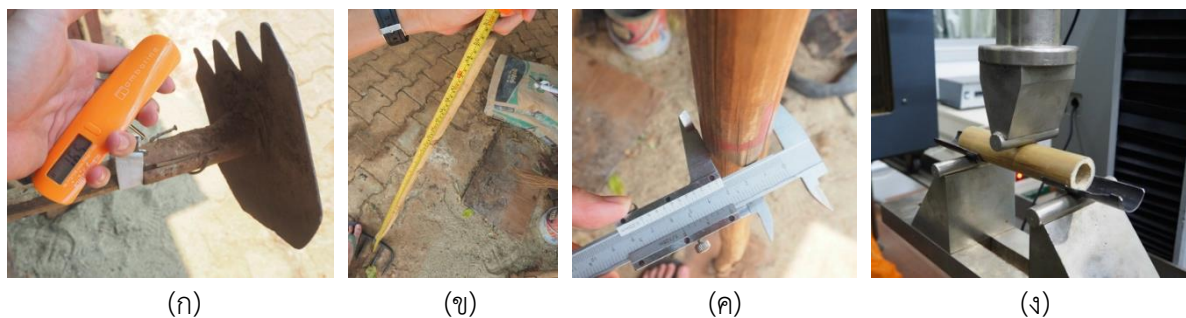
รูปที่ 4.10 การวัดค่าทางกายภาพของเครื่องมือดับไฟป่า (ก) การชั่งน้ำหนักเครื่องมือดับไฟป่า (ข) การวัดความยาวจากปลายส่วนหัวจนถึงปลายด้ามเครื่องมือดับไฟป่า (ค) การวัดขนาดเส้นผ่านศูนย์กลางกลางภายนอกของด้ามเครื่องมือดับไฟป่า และ (ง) การทดสอบการงอด้ามเครื่องมือดับไฟป่า
