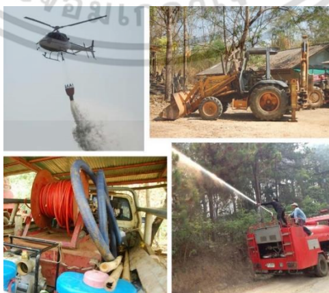
รูปที่ 2.5 ตัวอย่างเครื่องจักรกลที่ใช้ในงานดับไฟป่า ได้แก่ เฮลิคอปเตอร์โปรยน้ำ รถแทรกเตอร์
