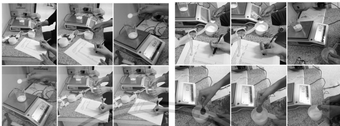
ภาพที่ 6.11 ทดสอบประสิทธิภาพอุปกรณ์สำหรับเครื่องปรุงรสกายภาพผง ด้วยเครื่องชั่งทศนิยม 2 ตำแหน่ง
