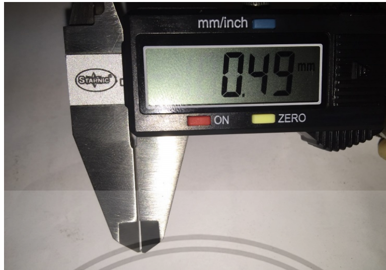
รูปที่ 4.15 ผลึกเพชรขนาด 490 \mu\text{m} ที่ได้จากการวัด ด้วยดิจิตอลเวอร์เนียร์ ก่อนเพิ่มขนาด
