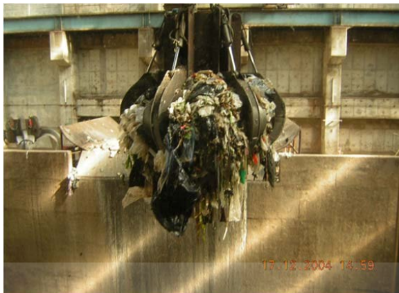
รูปที่ 3.8 ตัวอย่างบริเวณบ่อพักขยะและบ้นจั่นคืบมูลฝอย [9]
