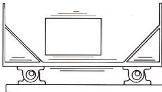
ภาพที่ 2.17 อุปกรณ์ทดสอบการสิ้นสะท้อนโดยวางบรรจุภัณฑ์บนหิ้งที่ สิ้นสะท้อนไปตามลูกเบี้ยวที่อยู่ข้างล่าง ที่มา: สายพิณ เครือคล้าย (2555)
