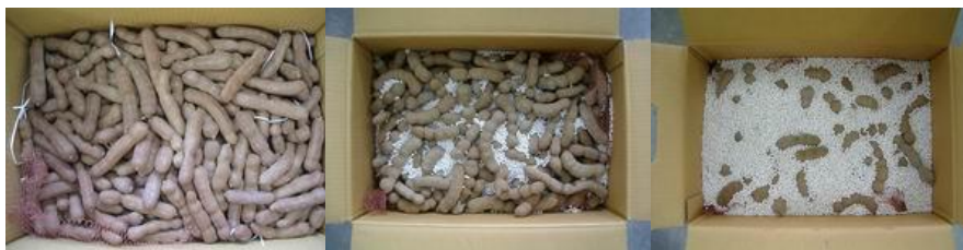
ภาพที่ 1.7 บรรจุภัณฑ์มะขามใช้เม็ดโฟมโพลีสไตรีน EPS (Expand Polystyrene) เป็นวัสดุกันช้ำ ที่มา: ดลหทัย ราชานุเคราะห์ (2551)
