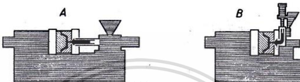
ภาพที่ 2.6 ลักษณะของเครื่องฉีดพลาสติกแบ่งตามทิศทางการฉีด
