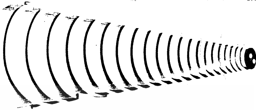
รูปที่ 4.3 สายอากาศโคเนคอลล็อกสไปเรียล Conical Log Spirals
