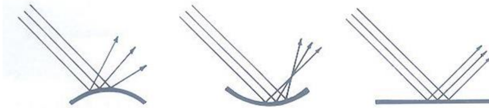
รูปที่ 2.24 แสดงแสงตกกระทบกับตัวอย่างรูปทรงวัสดุสะท้อน และทิศทางของการกระจายแสง ที่มา : Lam, William M.C. (1986:292) Sunlighting as Formgiver for Architecture
