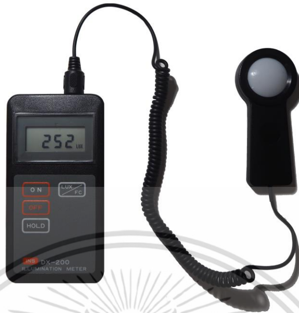
รูปที่ 3.3 แสดงอุปกรณ์วัดค่าแสงลักซ์มิเตอร์ (LUX Meter)
