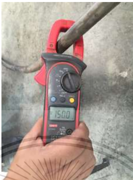
รูปที่ 4.16 การเช็คกระแสเชื่อมด้วยคลิปแอมป์
