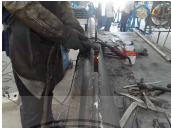
รูปที่ 4.20 ตัดกันเลยเส้นเกลียวออกและตัดเนื้อเหล็กของท่อที่เหลือไว้ตอน CNC
