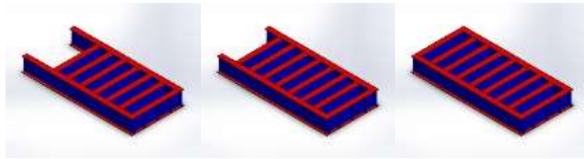
ภาพที่ 3.8 ลำดับขั้นตอนการประกอบโครงสร้างล่าง (ต่อ)
