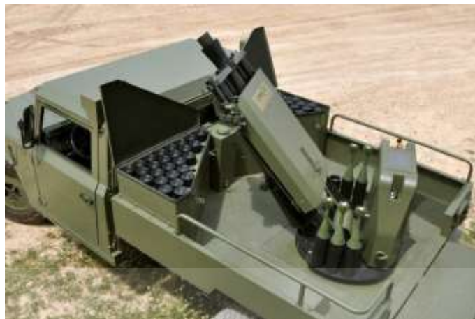
ภาพที่ 2.1 EXPAK EIMOS รถยนต์หุ้มเกราะ 4x4 ติดตั้งปืน ค.81 มม.หรือ ค.60 มม. จากประเทศสเปน
