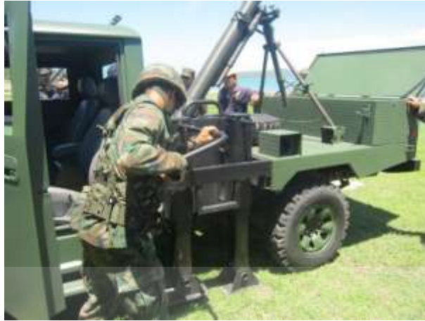
ภาพที่ 2.17 การเตรียมการทดสอบโดยทำการตั้งขาหยั่งเพื่อถ่ายแรงที่กระทำของปืน ค.120 มม. ลงสู่พื้นดิน
