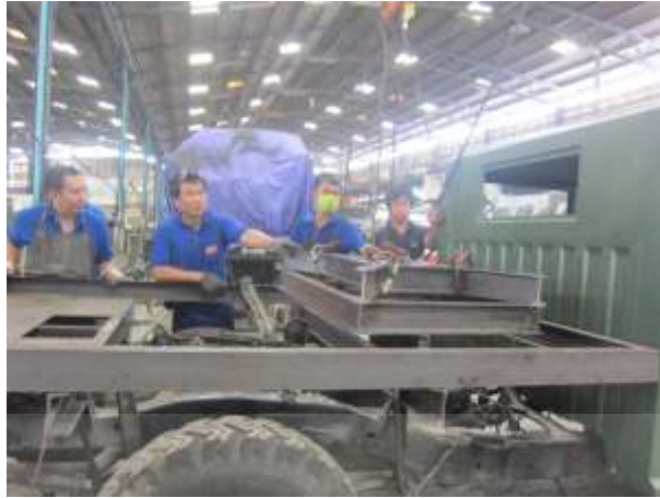
ภาพที่ 2.12 ขั้นตอนการนำโครงสร้างที่ได้มาทดสอบติดตั้งบนรถยนต์เพื่อกำหนดระยะของขาหยัง
