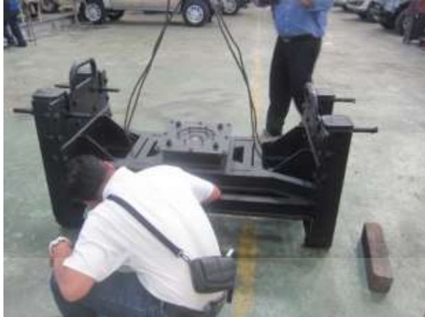
ภาพที่ 2.21 การถอดโครงสร้างฐานยิงปืน ค.120 มม. เพื่อตรวจสอบการทรวดตัว
