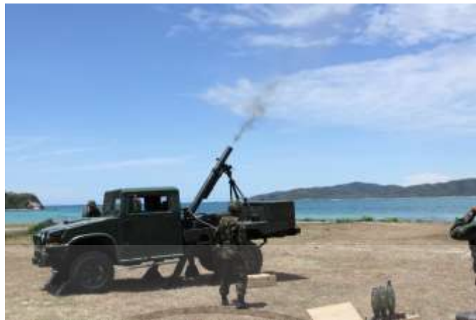
ภาพที่ 4.4 การยิงลูกระเบิดโดยใช้วิธีกระตุกเชือกสั้นไถยิง
