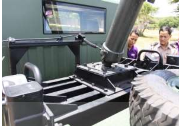
ภาพที่ 4.5 การตรวจสอบโครงสร้างฐานยิงปืน ค.120 มม.
