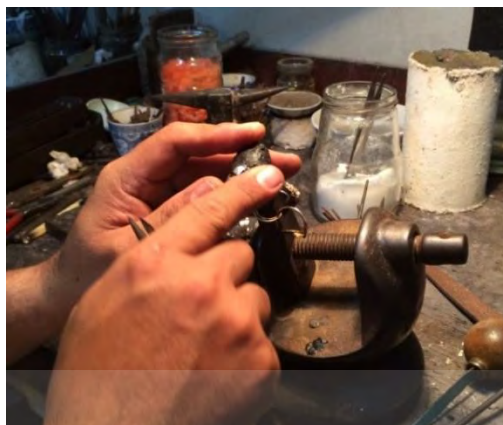
รูปที่ 2.41 ถอดกลไกของแหวน ติดแหวนกับครึ่งเพื่อเตรียมการแกะลาย
