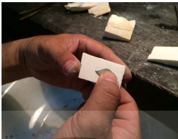
รูปที่ 2.36 สร้างแม่พิมพ์สำหรับการหล่อหน้าแหวนโดยใช้กระดองหมีก
