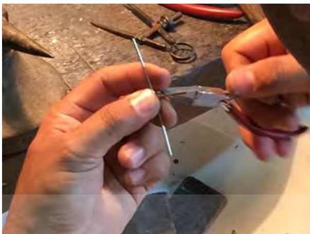
รูปที่ 2.16 มัดเส้นลวดโลหะที่วางเป็นเครื่องหมายบอกด้วยลวดเหล็ก
