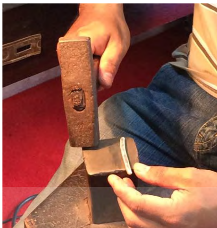
รูปที่ 2.8 ตีลดขนาดและปรับรูปทรงแท่งโลหะด้วยค้อนเหล็ก
