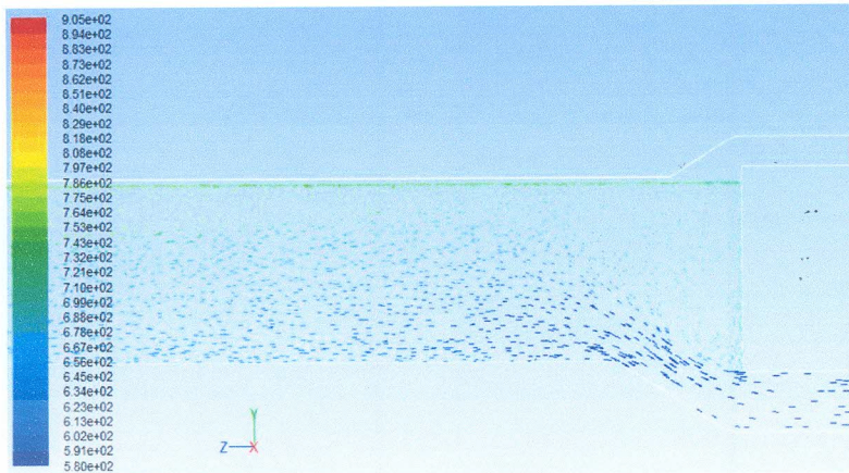
ภาพที่ 4.17 จากบริเวณ (A) ที่แสดงค่า Vector ความเร็วซึ่งแสดงตามสีของอุณหภูมิที่ Center Plane ช่วงทางเข้าของช่องการไหลอากาศดี โมเดลแบบที่ 1
