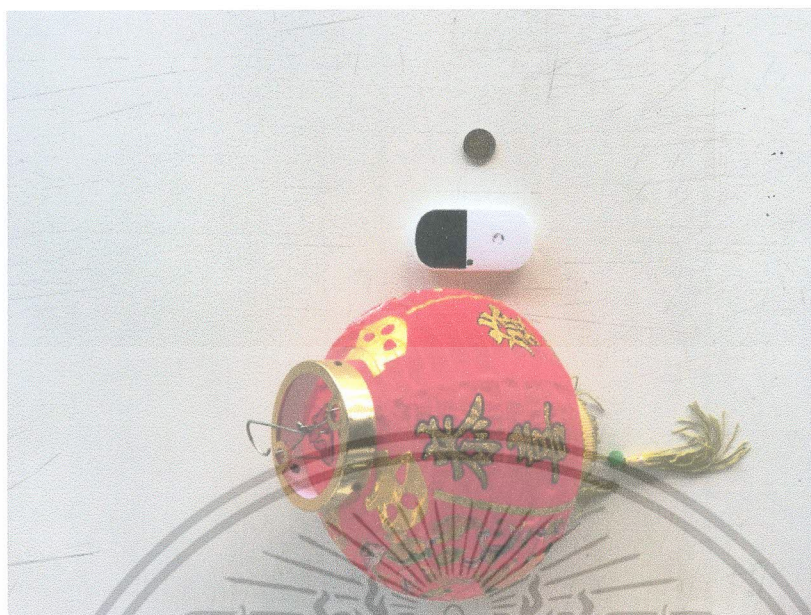
ภาพที่ 4.16 WIFI/3G Access Point แบบพกพาซ่อนใน โคมประดับรอบต้น
