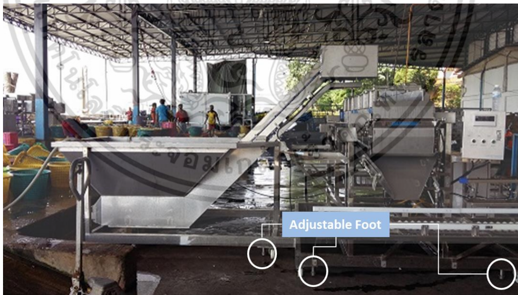
รูปที่ 4.1 ขาปรับระดับเครื่องชั่งอัตโนมัติที่นำเสนอ
