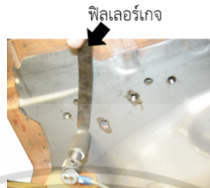
รูปที่ ก.35 วัดค่าช่องว่างของผิวตำแหน่งอ้างอิง
