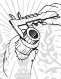
รูปที่ ก.44 การวัดขนาดภายนอกที่มีลักษณะเป็นร่องแคบ
