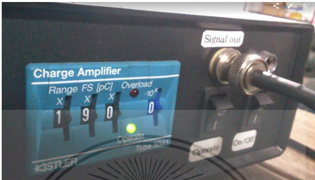
รูปที่ 5.15 ตัวขยายสัญญาณความดันในการเผาไหม้ (Charge amplifier)
