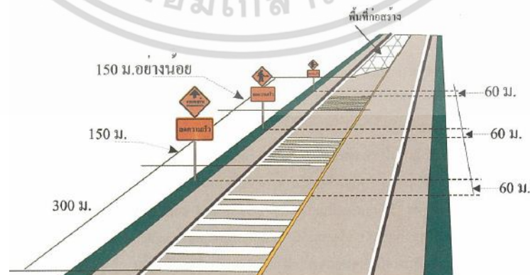
รูปที่ 2.35 การติดตั้งชะลอความเร็ว
