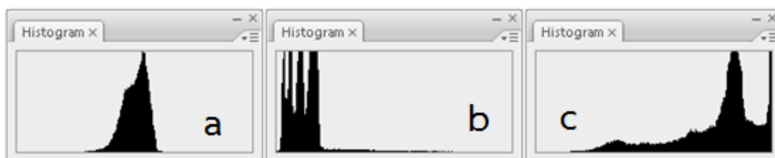
รูปที่ 2.3 ภาพแสดงลักษณะฮิสโตแกรมของภาพ (a) แบบคมชัดต่ำ (b) แบบมืด (c) แบบสว่าง
