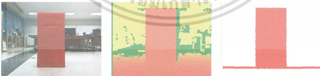
รูปที่ 4.2 ตัวอย่างแสดงการเปรียบเทียบ ภาพสีที่ได้ (RGB) ภาพที่ได้จากการแปลงค่าความลึกจากเซนเซอร์ตามสเกลสีจากรูปที่ 4.1 และภาพที่ได้จากการตัดส่วนของวัตถุในระยะ \pm 50 โดย วัตถุที่ระยะห่างจากกล้องเป็น 1,500 มิลลิเมตร
