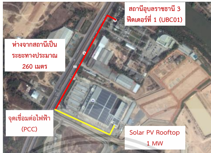
รูปที่ 4.2 Solar PV Rooftop ขนาด 1 MW เชื่อมต่อเข้าระบบจำหน่ายที่ฟีดเดอร์ UBC01
