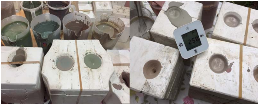
ภาพที่ 3.15 หล่อชิ้นงาน(จับเวลา)
