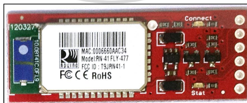
รูปที่ 2.15 ตัวส่งสัญญาณบลูทูธ รุ่นบลูทูธเมทโกลด์ (Bluetooth Mate Gold)[20]
