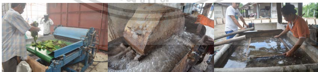
ภาพที่ 6.9 การแปรรูปเศษผ้าด้วยเทคนิคการผนวกรวมระหว่างใยผ้าและเยื่อสา
