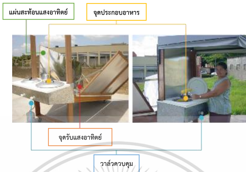
รูปที่ 2.26 องค์ประกอบเตาพลังงานแสงอาทิตย์แบบถ่ายเทความร้อนผ่านตัวกลาง
