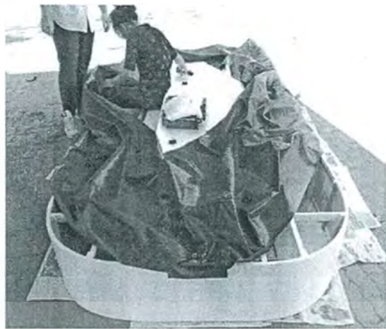
ภาพที่ 3.45 ติดตั้งเบาะอากาศบริเวณด้านนอกตัวเรือ
