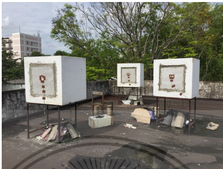
รูปที่ 3.20 แสดงการทดสอบผนังก่อ โดยวางกล่องทดสอบบนอาคารกลางน้ำ คณะสถาปัตยกรรมศาสตร์ สถาบันเทคโนโลยีพระจอมเกล้าเจ้าคุณทหารลาดกระบัง และหันหน้ากล่องไปทางทิศใต้
