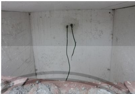
รูปที่ 3.2 แสดงลักษณะการติดตั้งสายเทอร์โมคัปเปิล (Sensor) ที่ภายในกล่องทดลอง
