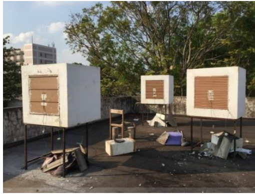
รูปที่ 3.23 แสดงการทดสอบการนำวัสดุไม้ประกอบพลาสติกมาใช้กับผนังก่อ โดยวางกล่องทดสอบบนอาคารกลางน้ำ ชั้นดาดฟ้า คณะสถาปัตยกรรมศาสตร์ สถาบันเทคโนโลยีพระจอมเกล้าเจ้าคุณทหารลาดกระบัง และหันหน้ากล่องไปทางทิศใต้
