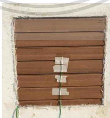
รูปที่ 3.4 แสดงลักษณะการติดตั้งสายเทอร์โมคัปเปิล (Sensor) ที่ผิวนอกกล่องทดลอง
