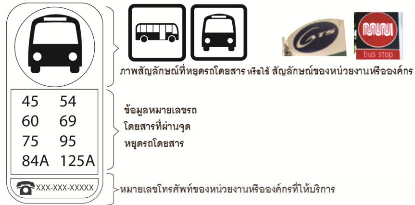
ภาพที่ 2.6 ข้อมูลในป้ายสัญลักษณ์หยุดรถโดยสารประจำ
