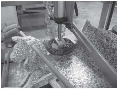
รูปที่ 4 การทดสอบความแข็งแรงของเท้าแขน ใช้แรงกด 800 นิวตัน กระทำ ณ ตำแหน่งใดๆ ที่อาจเกิดการเสียหายง่ายที่สุดของเท้าแขน จำนวน 10 ครั้ง
