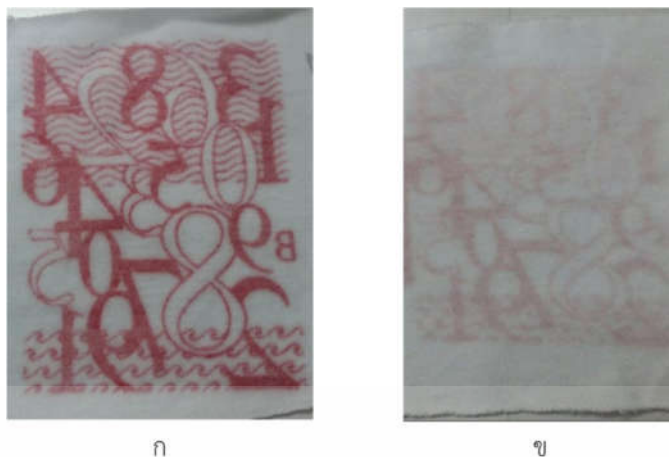
รูปที่ 4.43 ภาพถ่ายด้านหลังชิ้นงานผ้าฝ้าย 100% ที่ถูกสกรีนและอบที่อุณหภูมิ 80°C : ก) ผ้าฝ้าย 100% เบอร์ 70 และ ข) ผ้าฝ้าย 100% เบอร์ 40
