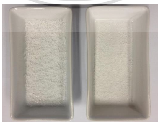
รูปที่ 4.15 ลักษณะแถ้แกลบ RHW และ RHR ที่ผ่านการเผาด้วยอุณหภูมิ 800 °C เป็นเวลา 5 ชั่วโมง เอกสารนี้เป็นเอกสารที่สงวนไว้สำหรับการใช้งานเพื่อการศึกษาเท่านั้น เมื่อผู้เช่าได้เห็นว่าไปใช้ประโยชน์ด้านการค้า ไม่ว่าจะกรณีใดๆ ทั้งสิ้น อีกทั้งห้ามมิให้ตัดแปลงเนื้อหา และต้องอ้างอิงถึงเจ้าของเอกสารทุกครั้งที่มีการนำไปใช้
