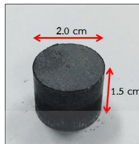
รูปที่ 3.1 เม็ดสารตั้งต้น 2\text{Mg}+\text{Si} ที่ผ่านการผสมและอัดแล้ว
