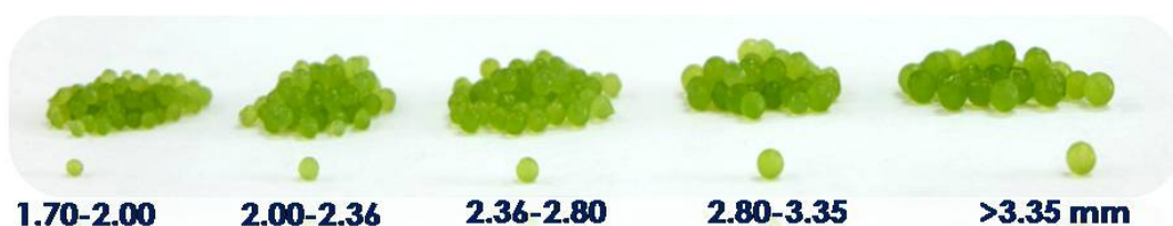
รูปที่ 3.4 เม็ดเซลล์ตรึง Tetraspora sp. CU2551 ที่มีเส้นผ่านศูนย์กลางขนาดต่างๆ
