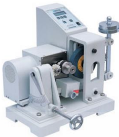
รูปที่ 3.7 การทดสอบความต้านทานการขัดถูด้วยเครื่อง Akron abrasion tester [53]
