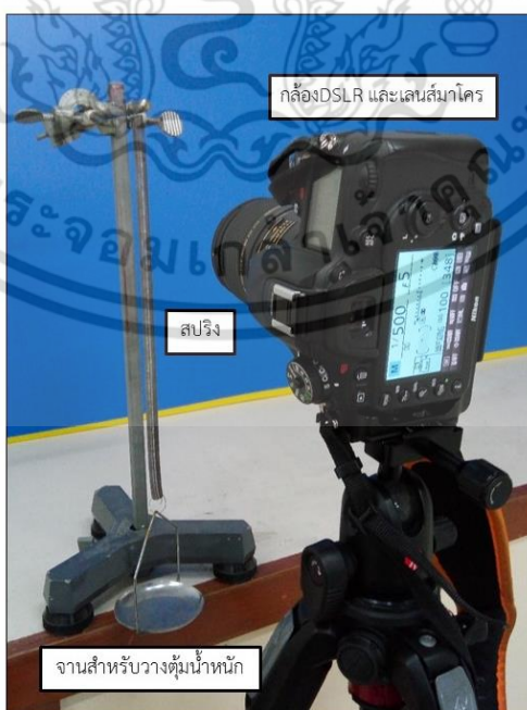
รูปที่ 3.1 การจัดอุปกรณ์เพื่อวัดการยืดตัวด้วยวิธีการดิจิทัลอิมเมจคอร์รีเลชัน
