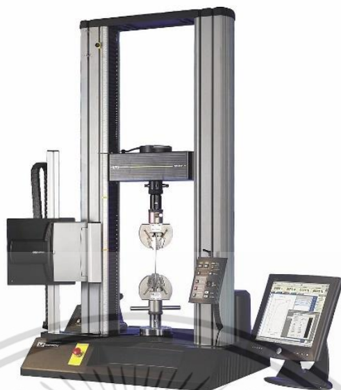
รูปที่ 2.7 เครื่องทดสอบแรงดึง Instron model 5566
