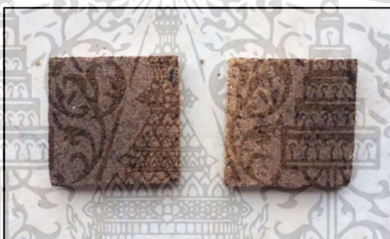
รูปที่ 3.11 ตัวอย่างชิ้นงานสำหรับใช้ทดสอบความหนาแน่น, ความชื้น, การพองตัวของความหนา และความต้านทานแรงดึงตั้งฉากกับผิวหน้า
