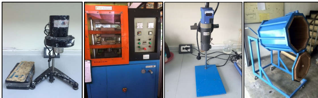
ก.) เครื่องวัดความหนืด ข.) เครื่องอัดขึ้นรูป ค.) เครื่องโฮโมจีไนเซอร์ ง.) ถังผสมขึ้นไม้กับกาว
