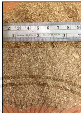
รูปที่ 3.7 ขนาดชิ้นไม้ยางพาราเบอร์ 3 (20-12 mesh)
