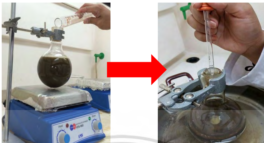
รูปที่ 3.4 เติมน้ำกลั่น 200 มิลลิลิตร และเติมไฮโดรเจนเปอร์ออกไซด์อีก 10 มิลลิลิตร ปั่นกวนต่ออีก 20 นาที
