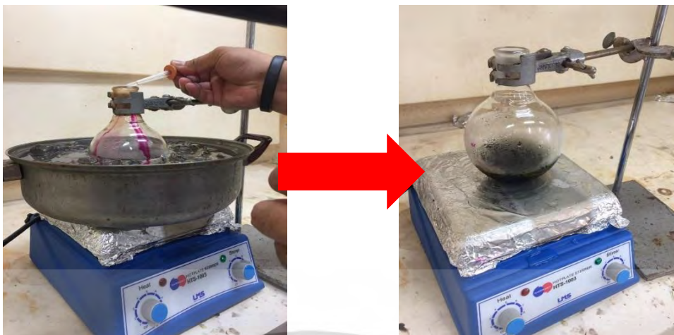
รูปที่ 3.2 เติมกรดซัลฟิวริกเข้มข้น และปั่นกวนต่อที่อุณหภูมิห้องเป็นเวลา 1 ชั่วโมง
