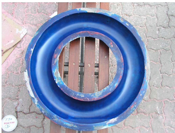
ภาพที่ 2.45 ชัดผิวให้สะอาดเรียบเป็นมันด้วยซีเมนต์ขัดแบบ
