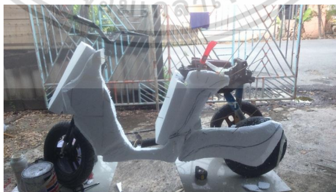
ภาพที่ 4.72 แสดงขั้นตอนการร่างแบบ รถไฟฟ้าตรวจการณ์
