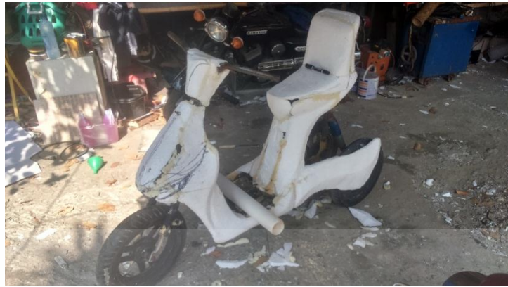
ภาพที่ 4.73 แสดงการตัดโฟรมเป็นรูปร่าง รถไฟฟ้าตรวจการณ์
