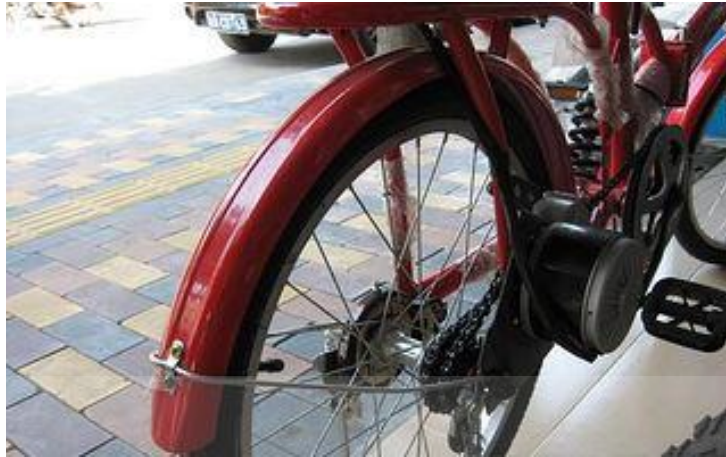
ภาพที่ 2.23 การติดตั้งมอเตอร์ดีซีแปรปร่ง่านแบบมีเฟืองทด
