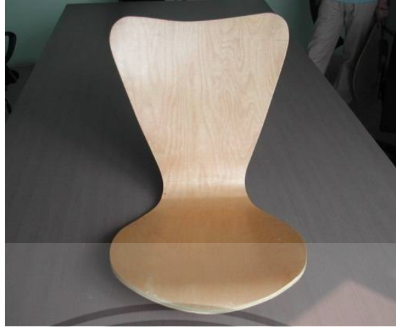
รูปที่ 4.14 การตัดแบบซ้อนชั้นนำไปใช้เป็นส่วนที่นั่งกับพนักพิง ที่มา : เว็บไซต์ http://capitalpolishers.com
