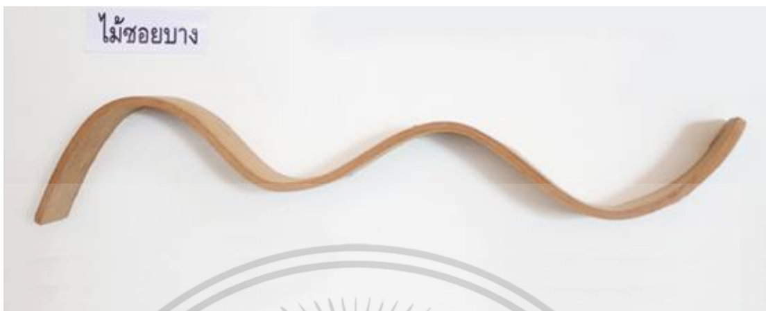
รูปที่ 4.12 การใช้ไม้บางซ้อนเป็นชั้น ที่มา : กัณฑ์อเนก เรไร (2559)
