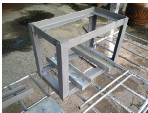
ภาพที่ 4.32 แสดงเหล็กฉากที่ผ่านการเชื่อมโดยการขึ้นโครง ภาพถ่ายโดย ดิสร พิณทอง
