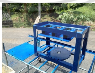
ภาพที่ 4.34 นำเครื่องต้นแบบมาพ่นสีเพื่อป้องกันการขึ้นสนิม ของเหล็ก
