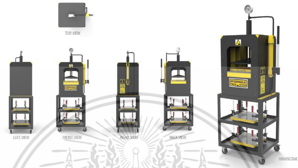
ภาพที่ ฉ.10 ภาพการเขียนแบบ เครื่องอัดแผ่นวัสดุธรรมชาติ (ภาพประกอบโดย ดิสร พินทอง)
