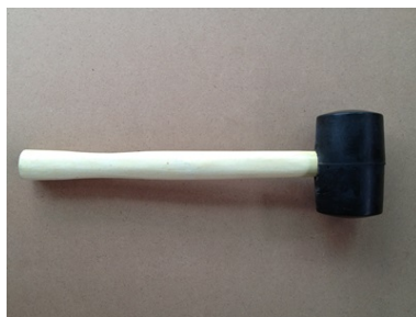
ภาพที่ 4.58 ค้อนยาง ภาพถ่ายโดย ดิสร พิณทอง
