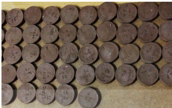
ภาพที่ 29 การอัดขึ้นทดสอบสีก่อนเผาของ เนื้อดิน ภาพโดย : ชุติมา งามพิพัฒน์
