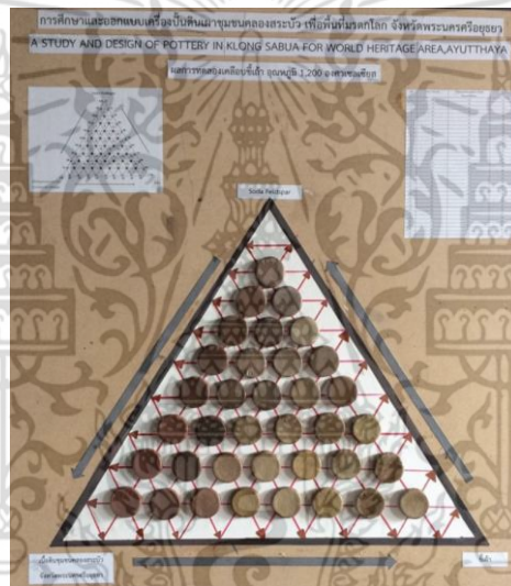
ภาพที่ 35 ชั้นทดสอบน้ำเคลือบ 36 จุด อุณหภูมิ 1,200 องศาเซลเซียส ภาพโดย : ชุตินา งามพิพัฒน์
