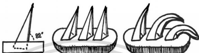
ภาพที่ 2.43 การวางฟันวัดอุณหภูมิและการล้มของฟันวัดอุณหภูมิ ภาพโดย : ชุตติมา งามพิพัฒน์ (4 มีนาคม 2558)
