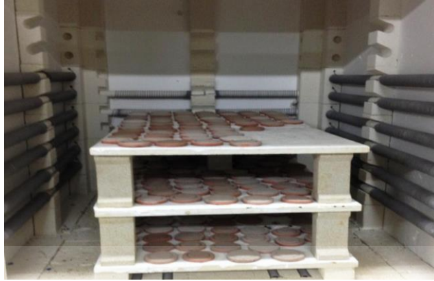
ภาพที่ 34 เเผ่ชั้นทดสอบน้ำเคลือบ 36 จุด อุณหภูมิ 1,200 องศาเซลเซียส ภาพโดย : ชุตินา งามพิพัฒน์
