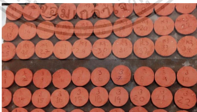
ภาพที่ 31 การอัดขึ้นทดสอบสีหลังเผาของเนื้อดิน ภาพโดย : ชุติมา งามพิพัฒน์
