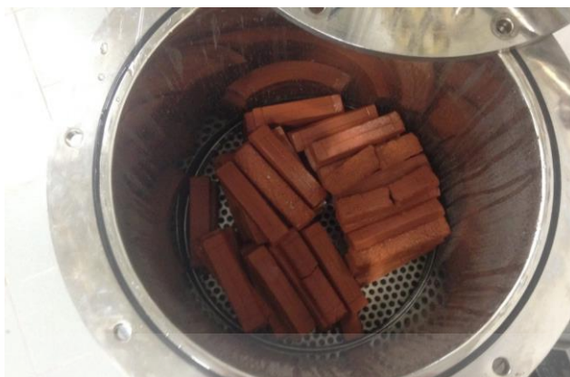
ภาพที่ 31 การทดสอบการดูดซึมน้ำ ภาพโดย : ชุติมา งามพิพัฒน์
