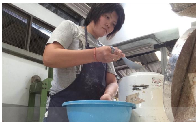
ภาพที่ 37 ชั่งอัตราส่วนผสมของน้ำเคลือบจำนวน 5 กิโลกรัม ภาพโดย : ชุติมา งามพิพัฒน์
