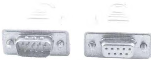
รูปที่ 2.53 DB9 ด้านชายคือตัวผู้ (Male) และด้านขวาคือตัวเมีย (Female) [26]
